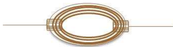
BOBINA DE ALAMBRE MAGNETO CON 5 VUELTAS
